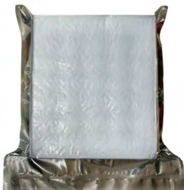
Sele a bandeja com um saco antiestático
