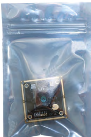
Sele a bandeja com um saco antiestático
